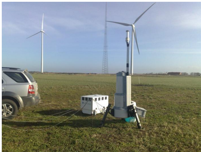
Рис.2. Слева - ветровой полностью волоконный профайлер Windcube-фирмы LEOSPHEREи справа QinetiQ/NaturalPowerZephIR.
