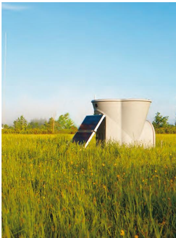
Рис.1. Трехлучевой содар TRITON имеет высоту зондирования 200м.
