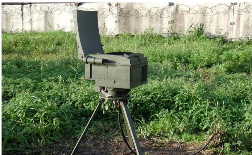
Рис.8. Ветровой профайлер миллиметрового диапазона длин волн 1Б67-1. (Тула, ЦКБА)
