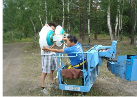
Рис. 2. Компонировка радара в корзине подъемника
