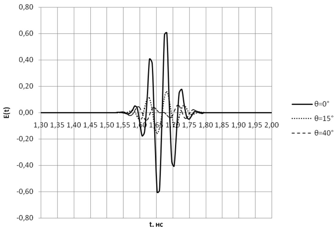
**Рис. 3в.** Импульсы рассеянного поля в разных направлениях при  $f_0\tau = 1,5$ .
