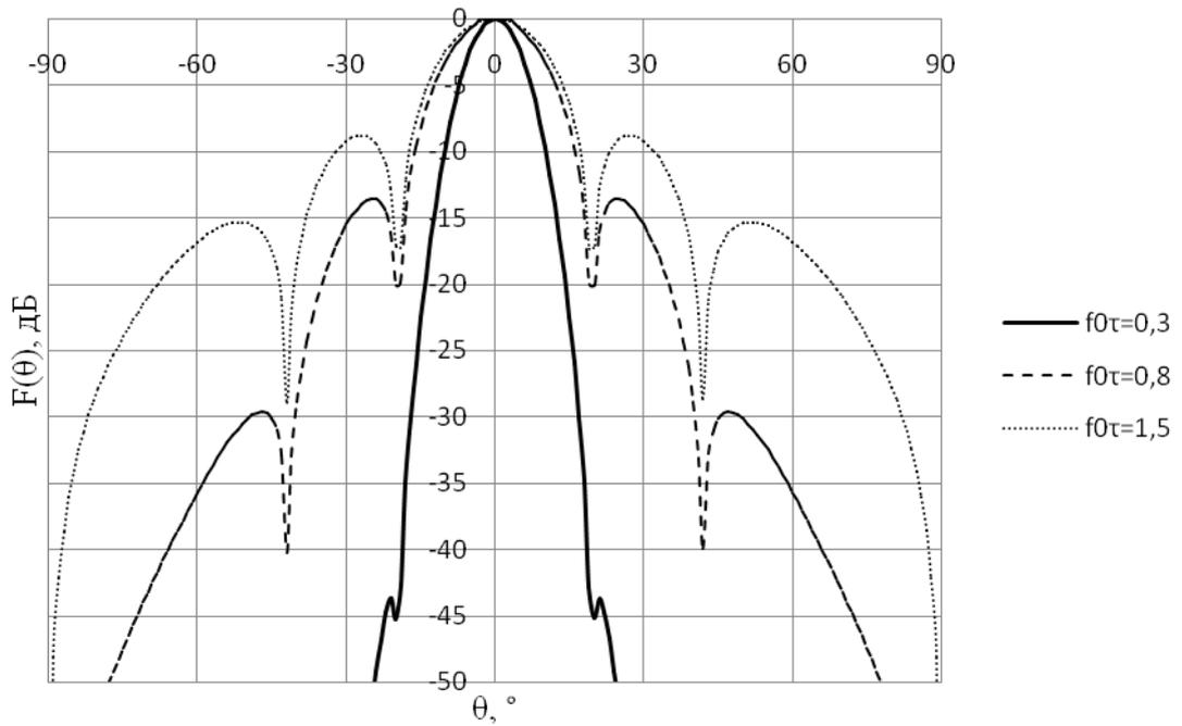
**Рис. 4. Импульсная ДН в Е-плоскости.**
