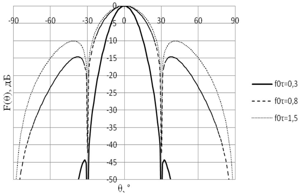
**Рис. 5. Импульсная ДН в Н-плоскости.**
