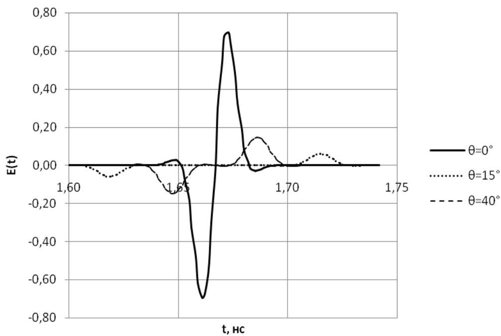
Рис. 3а. Импульсы рассеянного поля в разных направлениях при  $f_0\tau = 0,3$ .
