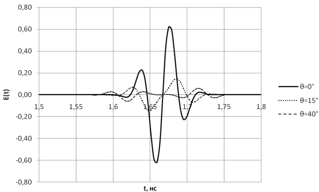
Рис. 3б. Импульсы рассеянного поля в разных направлениях при  $f_0\tau = 0,8$ .
