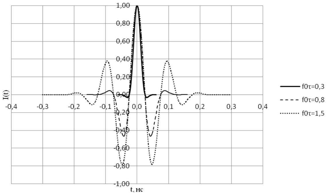
**Рис 2.** Возбуждающий импульс при разном значении  $f_0 \tau$ .
