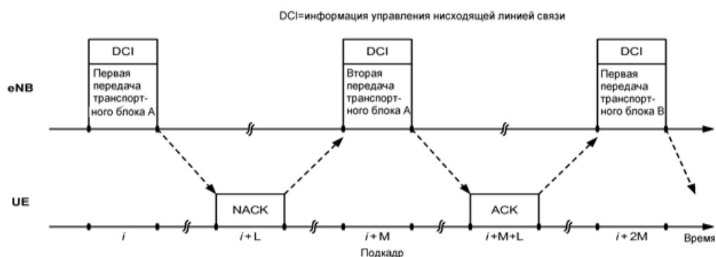
Рис. 2. Пример передачи данных по нисходящей линии связи посредством HARQ.
