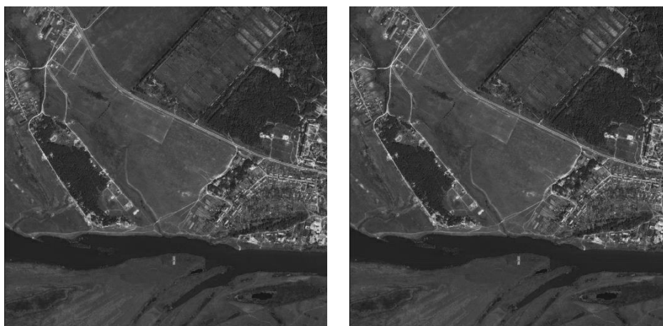
Рис.7. Изображения, восстановленные на приемной стороне - а) потеряны целые строки СКО=0,93; б) потеряны часть строк СКО=0,39
