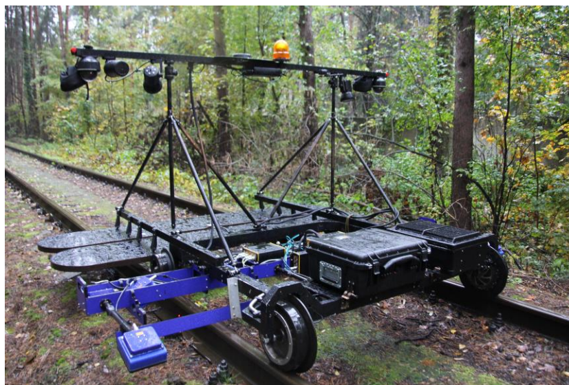
Рис. 2. Зондовая тележка с поисковым оборудованием
