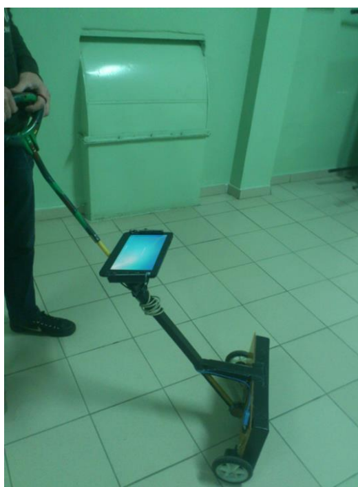
Рис.2. Лабораторный образец одноканального высокочастотного георадара
