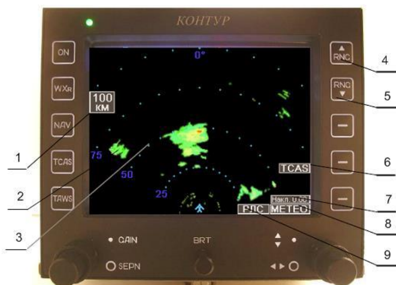
1 – индикация режима максимальной дальности; 2 – изображение гидрометеообъекта; 3 – радиальные метки дальности; 4-9 – технические метки и рабочие клавиши блока. Рис.1. Блок индикатора МНРЛС «Контур»
