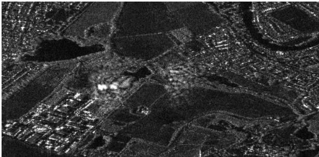
б) РЛИ с ошибкой угла отворота в 1/3 ширины антенны
