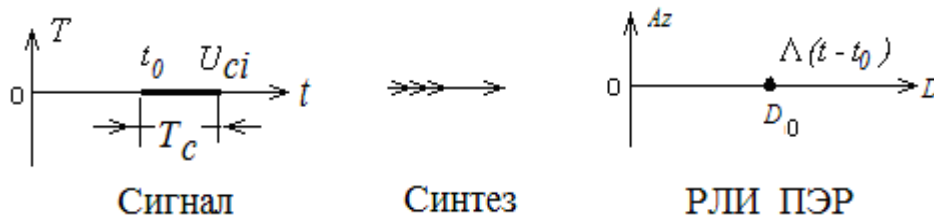
Рис. 3. Преобразование принятого сигнала в РЛИ ПЭР по координате дальность
