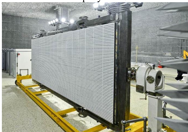
Рис. 1. Бортовая аппаратура РСА. Общая компоновка (а). Макет в БЭК (б).
