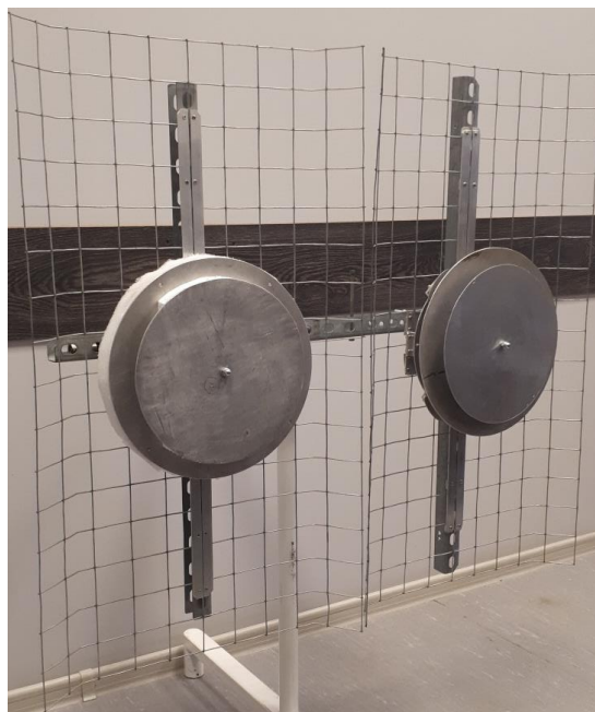
Рис. 4: Две антенны-прототипа. Слева – передающая антенна, справа – приемная.
