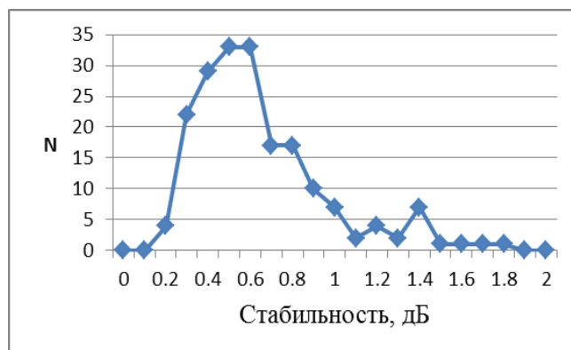
Рис. 2. Гистограмма распределения 200 нефтяных платформ в зависимости от стабильности отражения на НН поляризации
