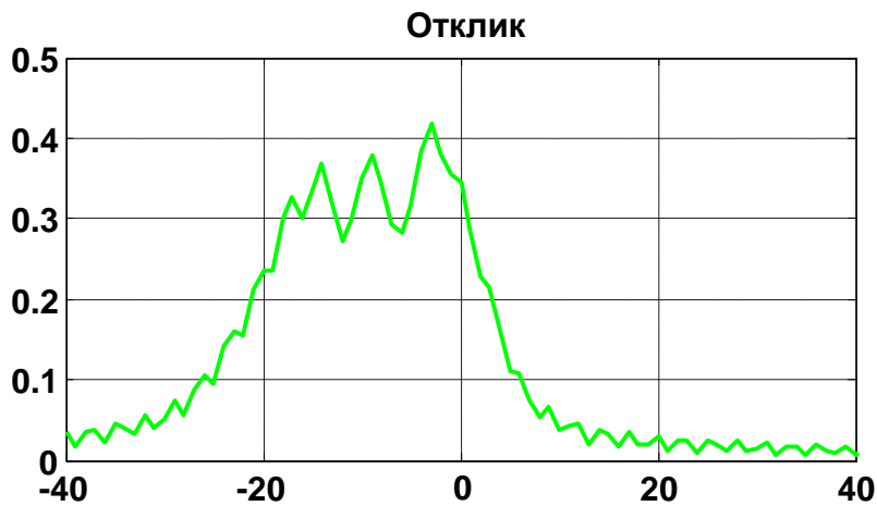
Рис. 10. Пример отклика системы обработки РЛС для T_c = 60 с при наличии флуктуационной ошибки оценки перемещения.
