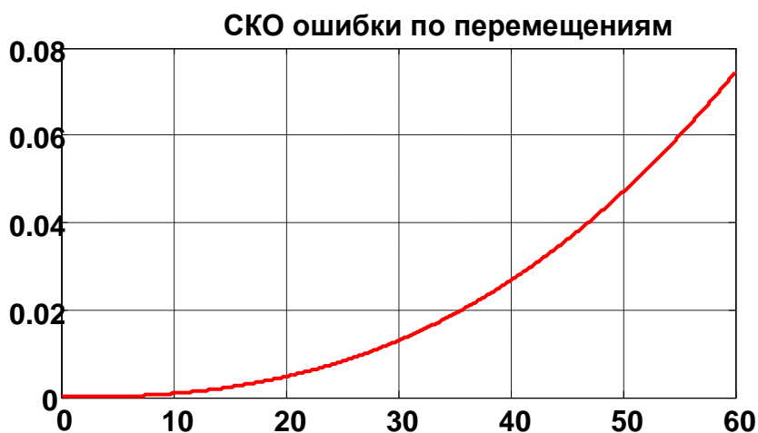
Рис. 11. Изменение СКО ошибки измерения перемещения на минутном интервале.
