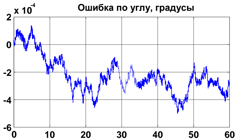
Рис. 6. Реализация ошибки по углу W_\beta(t) на минутном интервале времени.
