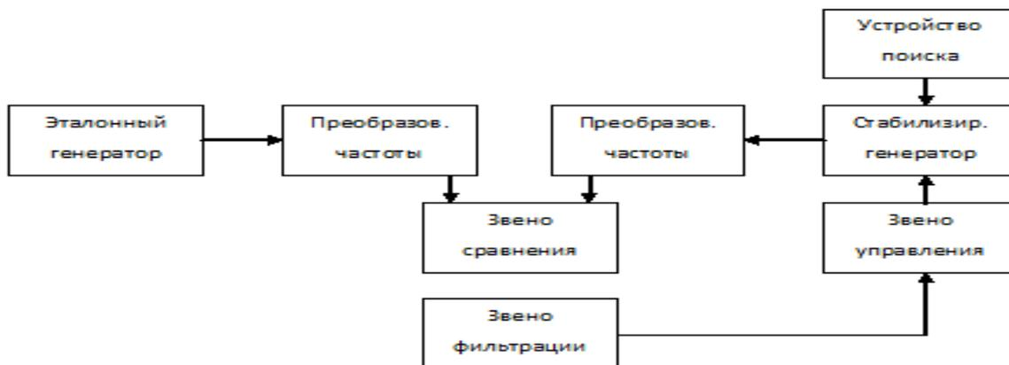
Рис. 1. Структурная схема АПЧ
