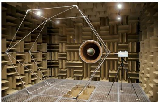
Рис.1. Акустическая безэховая камера
