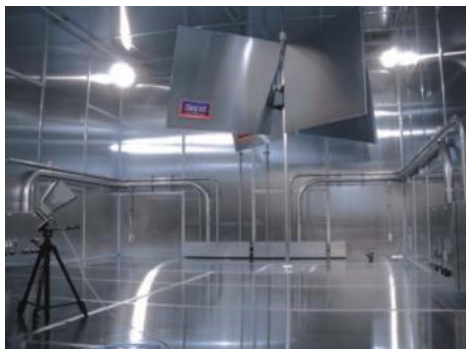
Рис.3. Акустическая реверберационная камера
