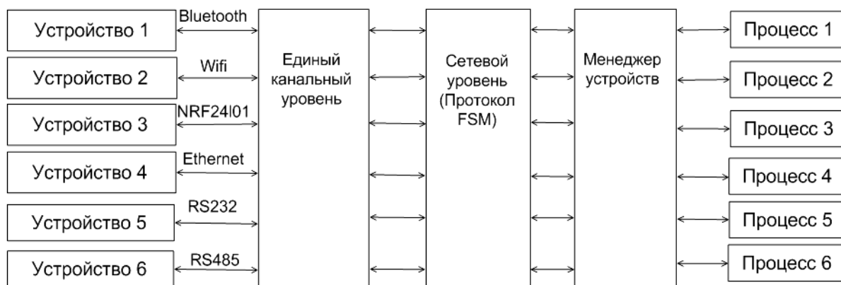
Рис. 1. Структурная схема организации стека FSM
