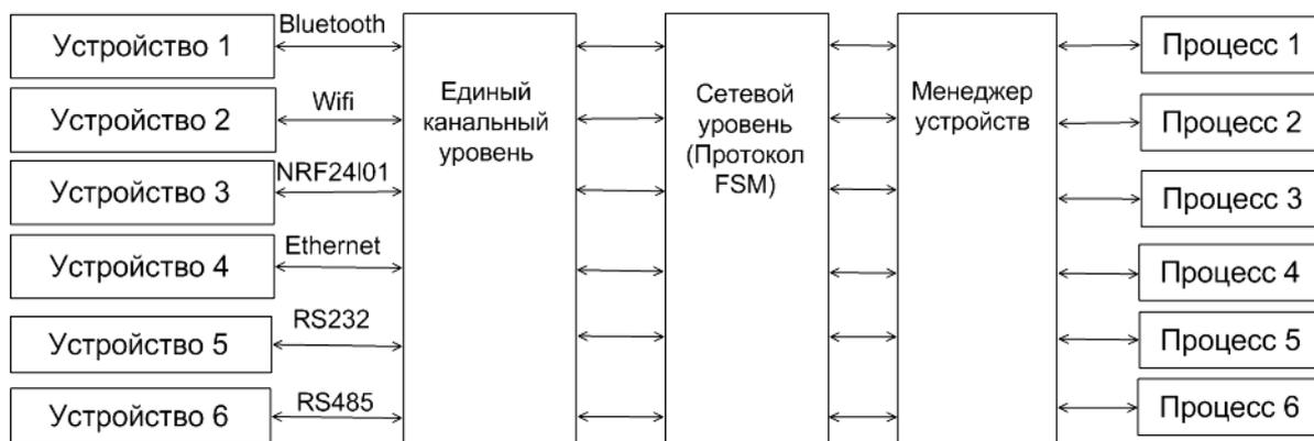
Рис. 1. Структурная схема организации стека FSM
