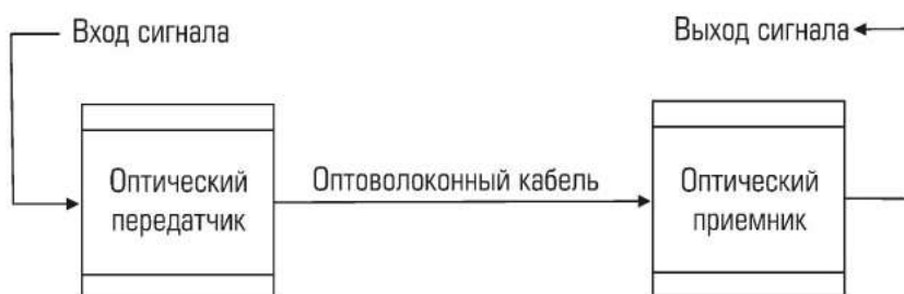
Рис. 1. Схема простейшей оптоволоконной системы передачи информации
