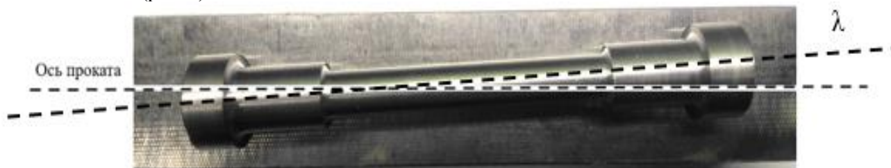
Рис. 2. Испытательный образец и угол несоосности \lambda
