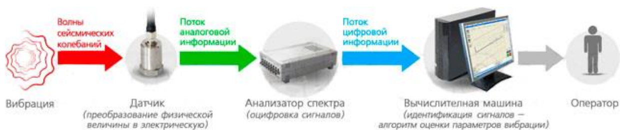
Рис. 2 — Структурная схема проведения вибрационных измерений
