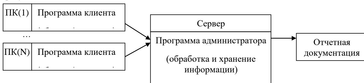
Рисунок 1 – Структурная схема системы мониторинга состояния компьютеров в локальной сети.
