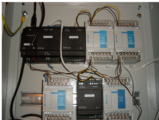
Рис. 2. Автоматизированная система измерения пористости материалов (подсоединение кабелей не показано)
