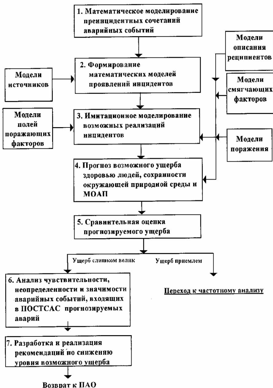
Рис.3. Блок-схема математического моделирования аварийных ситуаций
