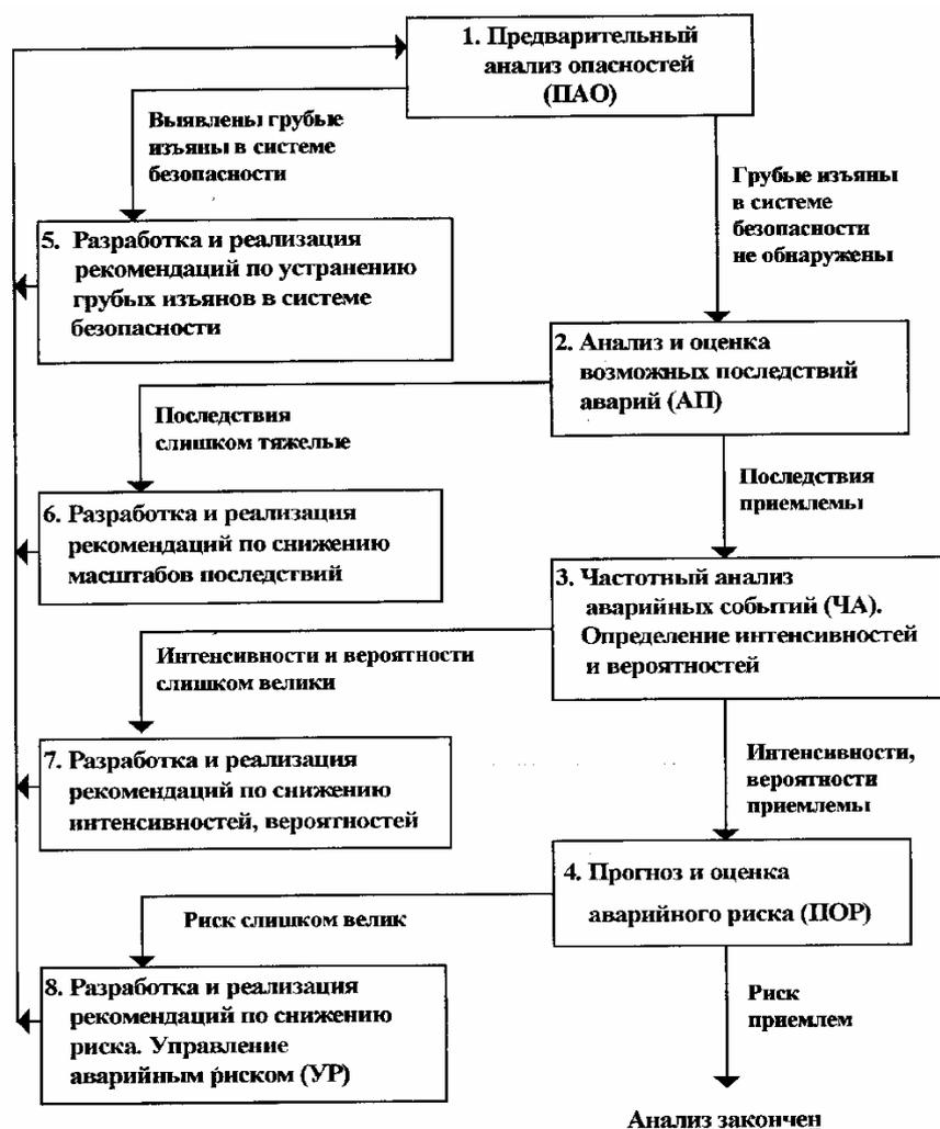
Рис.2. Блок-схема анализа аварийного риска
