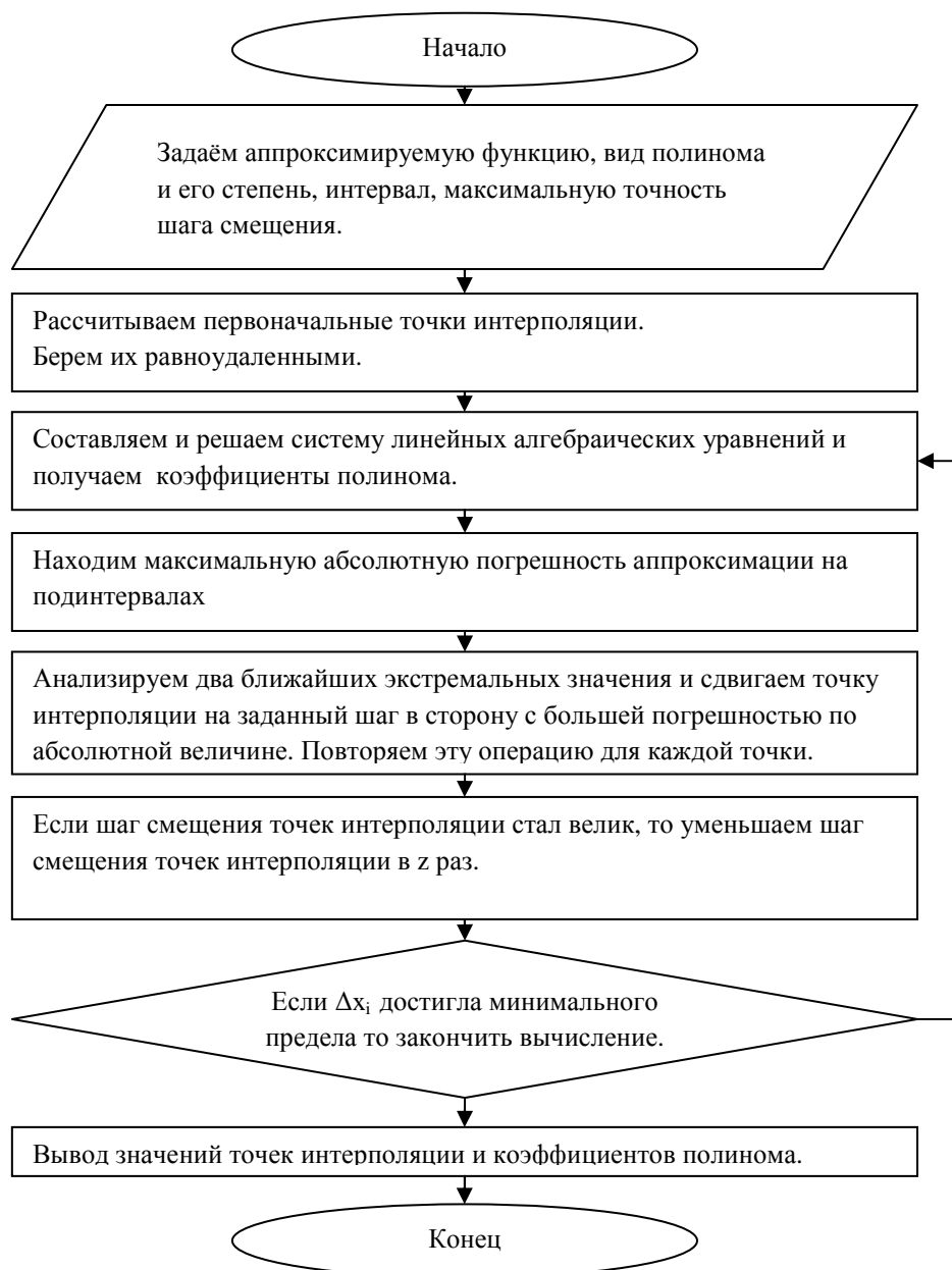
Рис. 2. Функциональная блок-схема поиска коэффициентов полинома наилучшего приближения по улучшенному алгоритму Ремеза
