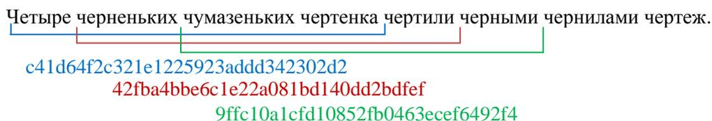
Рис. 1. Разбиение текста на шинглы внахлест
