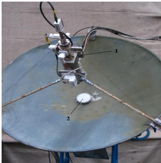
Рис. 1. К задаче введения в СВЧ радиометрическую систему сигнала генератора шума
