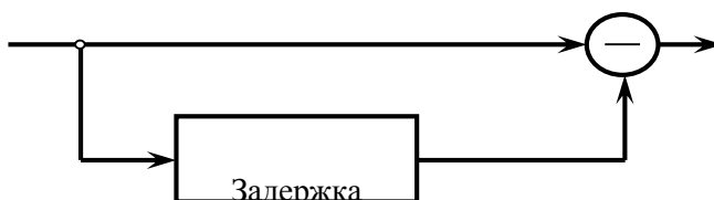
Рис. 1. Структурная схема однократной системы ЧПК
