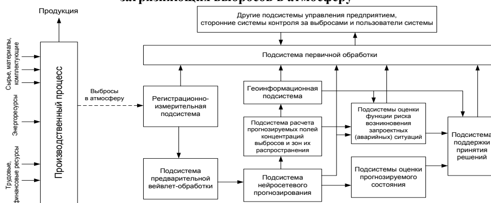
Рис. 2. Подсистема вторичной обработки временных рядов данных выбросов загрязняющих веществ в атмосферу
