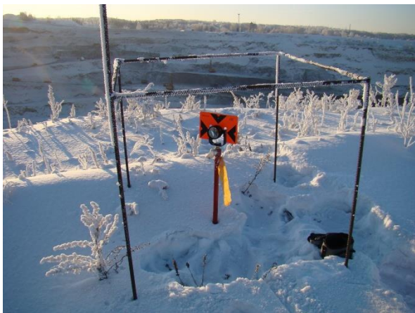
Рис. 1. Опорный репер с отражателем и предохранительным ограждением
