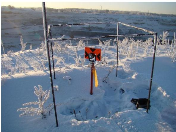
При закладке репера в массив коренных пород скважину полностью заливают бетоном.
