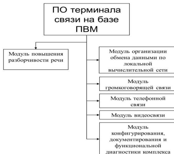
Рис. 1. Модульная архитектура программного терминала связи на базе ПЭВМ
