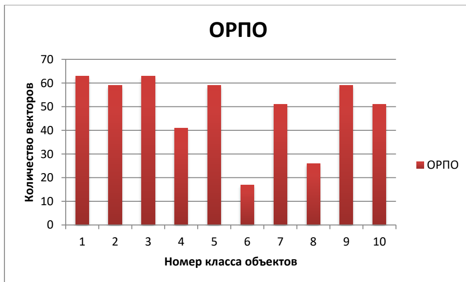
Рис. 3. Диаграмма количества векторов при вычислении центроидов классов для алгоритма формирования признаков по выпуклым оболочкам
