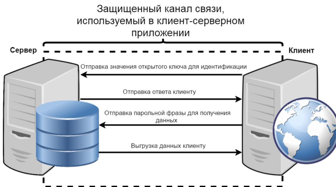
Рисунок 1 – Структурная схема протокола рукопожатия
