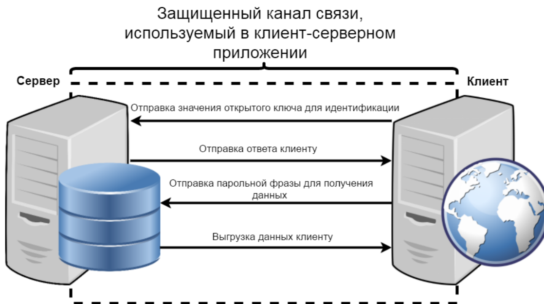
Рисунок 1 – Структурная схема протокола рукопожатия
