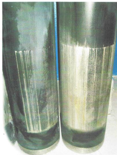
Рис. 1. Износ плунжера после эксплуатации
