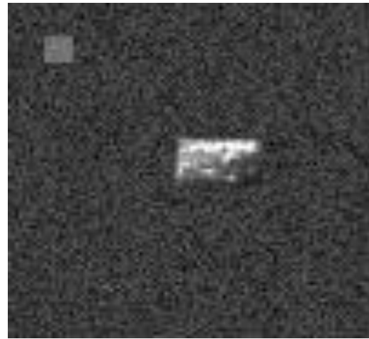
Рис.3. Фрагмент тестового изображения, на котором шум имеет распределение Вейбула
