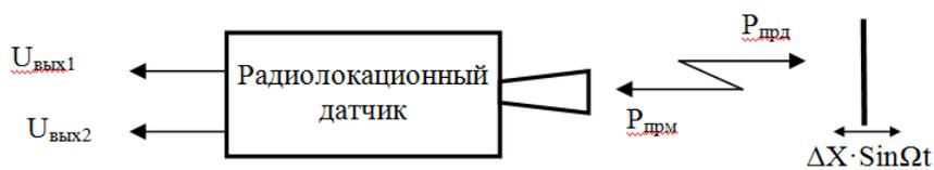
Рис. 3. Определение вибросмещений по фазе отраженного сигнала.
