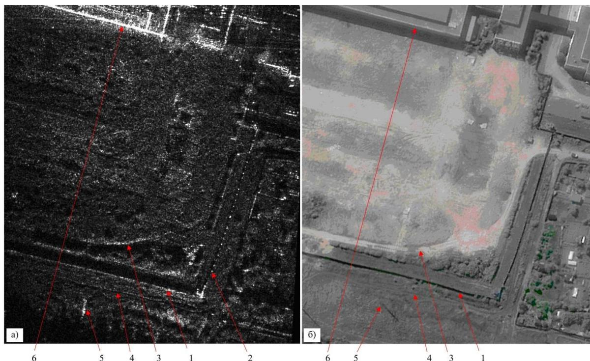
**Рис. 2. РЛИ с разрешением 0.25 м (а) и спутниковый фотоснимок (б) производственной площадки: 1 – ограждение, 2 – столбы ограждения, 3 – следы автомобиля на грунте, 4 – тропа, 5 – опора ЛЭП, 6 – здание.**
