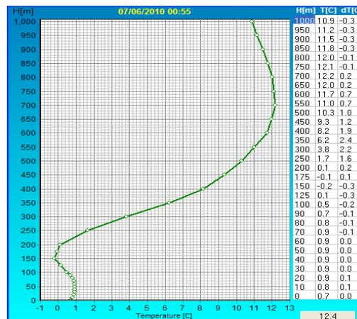
Рис. 3. Пример профиля температуры АПС, измеренного микроволновым температурным профилером МТР-5.
