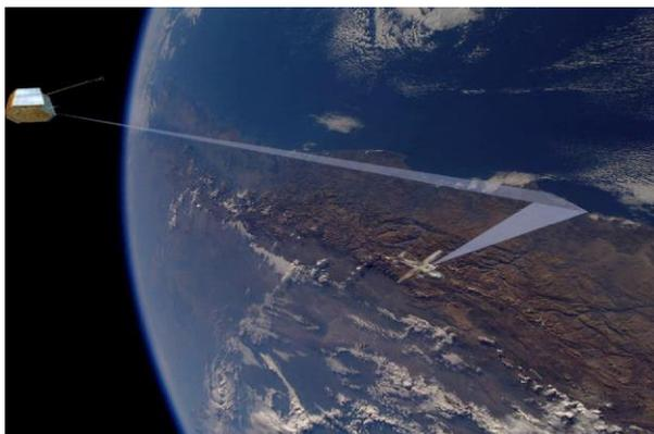
**Рис. 5. Схема проведения бистатического эксперимента TerraSAR-X – PAMIR**
