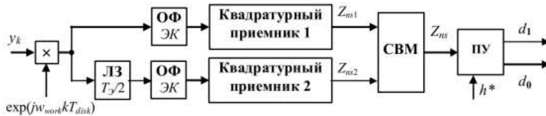
Рис. 3. Устройство обработки ФКМ сигнала с неизвестным временем прихода
