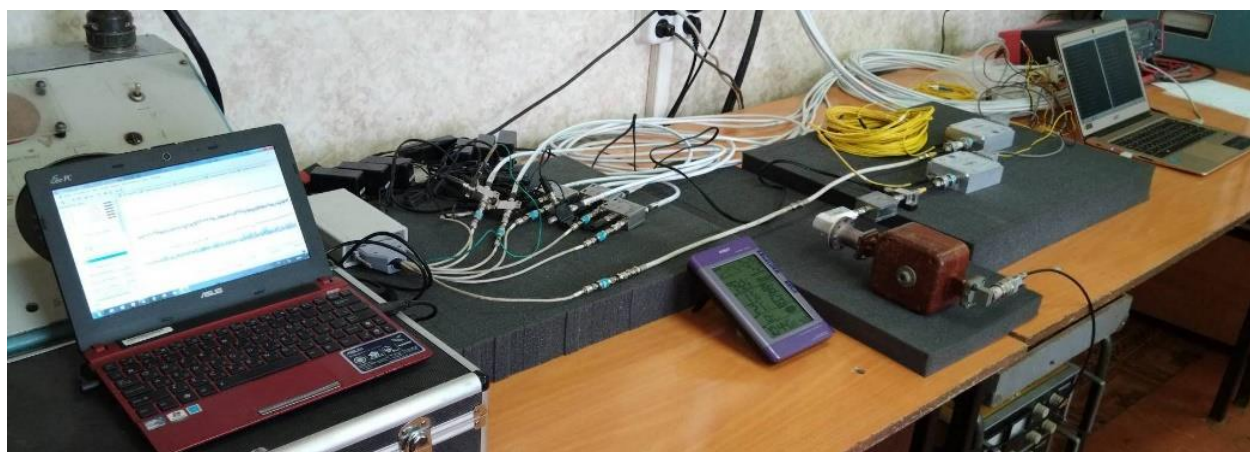
Рис. 4.2 Состав радиопотонного тракта передачи сигналов промежуточной частоты многочастотной микроволновой радиометрической системы
