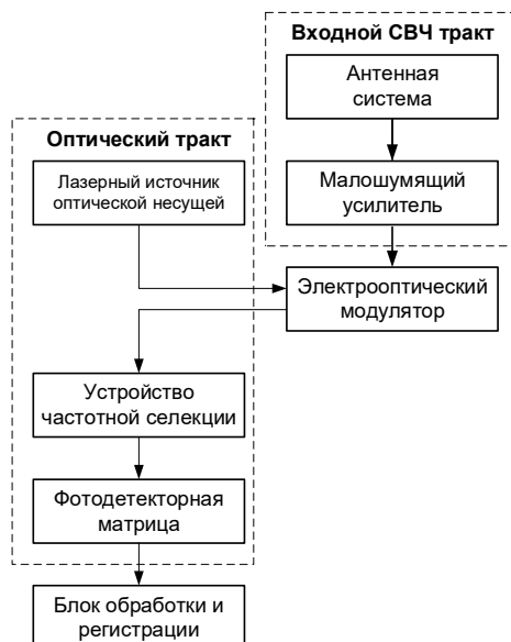
Рис. 2.1 Обобщенная структурная схема многочастотного радиофотонного приемного тракта
