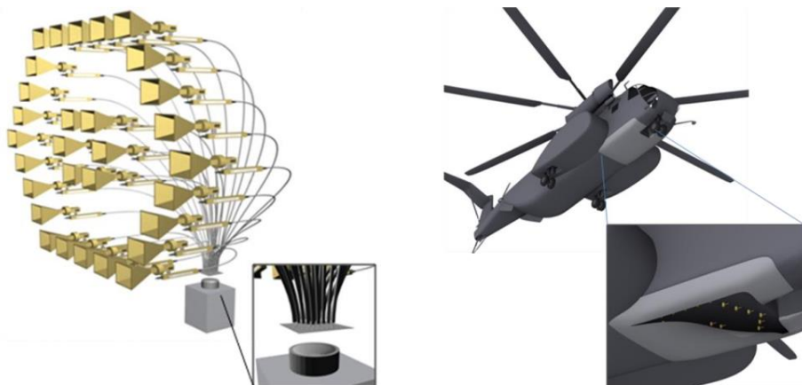
Рис. 2.1 Схематическое изображение радиофотонного радиометра с распределенной апертурой
