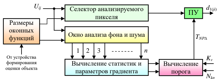
Рис. 8. Обобщенная структурная схема ПУЛТ процессора
