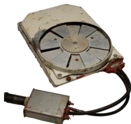
Рис. 2. На основе анализа многолетнего опыта работы с электростатическими флюксметрами на кафедре физики ВлГУ в 2008 году была разработана новая версия аналогового флюксметра ЭФ-1. В нем был использован в качестве привода двигатель от накопителя на жестких магнитных дисках персональной ЭВМ (винчестера). Основные достоинства: улучшенное подавление промышленной частоты 50 Гц.
