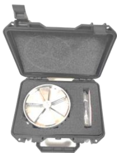
Рис. 9. В 2022 году разработан и создан флюксметр ПЧЕЛА-А2 (выпускаемая версия), предназначенный для измерения напряженности электрических полей широкого диапазона. Применяется в научных лабораториях, различных системах мониторинга и при проведении измерений в тяжелых полевых всепогодных условиях. Основные характеристики разработанного флюксметра: диапазон измерения \pm 10000 В/м; точность измерения 2 В/м; чувствительность устройства равна 0,2 В/м/мВ; реальная рабочая полоса частот устройства равна 4,5 Гц; неравномерность коэффициента передачи в полосе частот – 0,5 дБ, подавление сетевой помехи на частоте 50 Гц – не менее 40 дБ. (НПП «Электростатик»).
