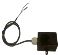
Рис. 10. В 2023 году создан цифровой датчик параметров атмосферы (НПП) (температуры, влажности и давления) NL-3DPAS, который выполняется на основе цифрового датчика температуры и давления MS5611, датчика влажности SHT31: погрешность по температуре \pm 0,2 °C ( в интервале 0...+90 °C); погрешность по температуре \pm 0,3 °C ( в интервале -40.-0 °C); погрешность по влажности \pm 2 %; погрешность по давлению \pm 1.5 %; напряжение питания 8...30 В.
