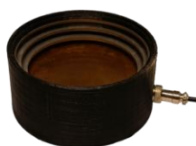
Рис. 11. Разработано и создано градуировочное устройство для электростатических флюксметров. Градуировочное устройство предназначено для автоматического определения поправочных переменных цифрового флюксметра, имеет равномерное распределение электростатического поля. (НПП «Электростатик»).
