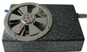
Рис. 5. В 2016 году создан вариант ЭФ-4 - аналоговый флюксметр в прямоугольном корпусе. Основные достоинства: улучшена двигательная группа стабильная частота вращения, больший срок службы двигателя. (НПП «Электростатик»).
