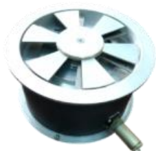
Рис. 4. В 2014 году был создан аналоговый флюксметр ЭФ-3 в корпусе диаметром 120 мм. Основные достоинства: улучшенная двигательная группа и системы управления двигателем. Основные характеристики разработанного флюксметра: диапазон измерения \pm 10000 В/м; точность измерения 2 В/м; чувствительность устройства равна 0,2 В/м/мВ; реальная рабочая полоса частот устройства равна 4,5 Гц; неравномерность коэффициента передачи в полосе частот – 0,5 дБ, подавление сетевой помехи на частоте 50 Гц – не менее 40 дБ. (НПП «Электростатик»).
