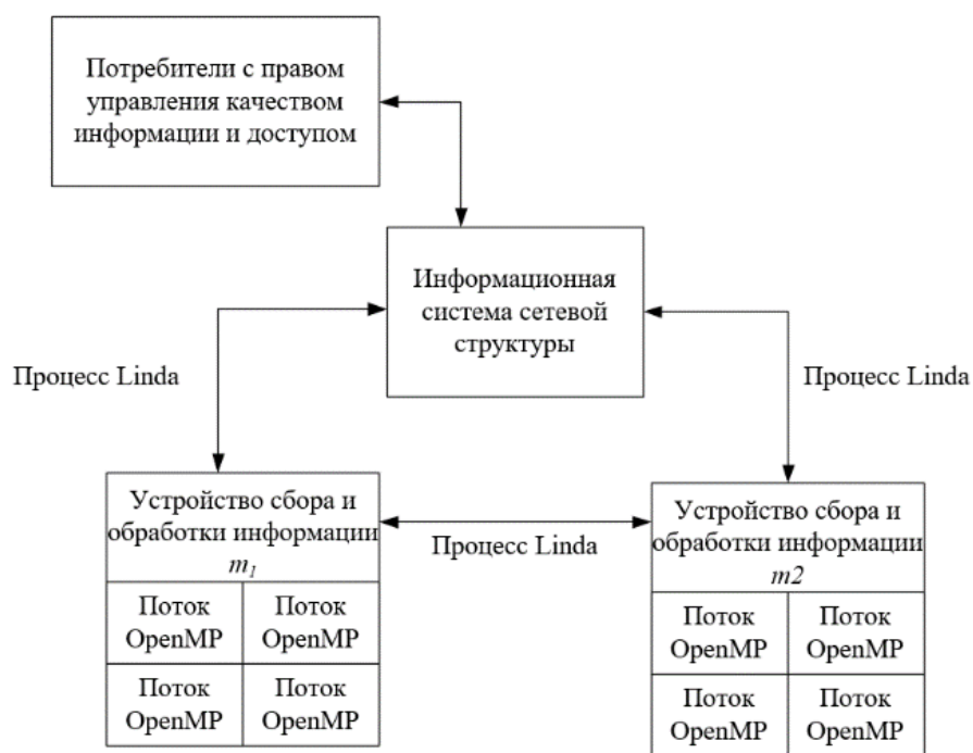
Рис. 3. Схема комбинированного метода параллельного программирования
