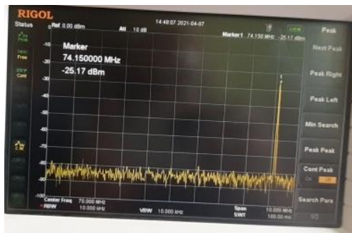
Рис. 4 – Выходной сигнал при V_T = 1,25 В
