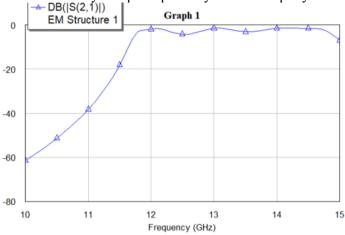
Результат теоретических данных и результатов моделирования различаются, при построении фильтра действенная частота оказалась выше и находится в пределах от 12  $\Gamma\Gamma$ ц до 16  $\Gamma\Gamma$ ц.
