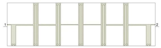
Данный фильтр имеет частотную характеристику полосно-пропускающего фильтра
