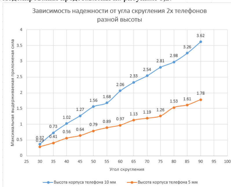
Рис. 1 График зависимости угла округления граней от силы, приложенной на эту грань двух корпусов
